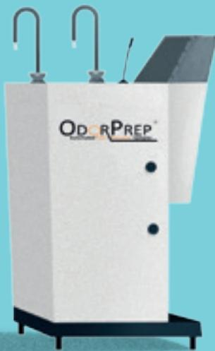
La centralina è dotata di sensori ancillari altamente sensibili che misurano in tempo reale la presenza di sostanze odorigene contenute nell'aria.
